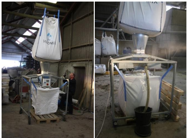
Figur 1. Eksempel på korrekt prøveudtagning af mineralske foderblandinger ved brug af cross-cut-sampler, hvor der udtages en repræsentativ prøve af hele bigbagens indhold.
